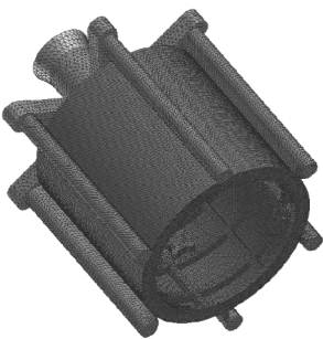
图 3 比例模型的有限元模型 Fig.3 Finite element model of the scale model
